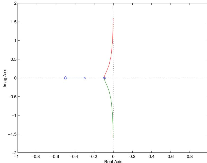
Il sistema è stabile per un dato valore di  $k$  se i corrispondenti valori sul luogo sono interni al cerchio di raggio unitario. Si ha che per  $k = 0$  il sistema è stabile se  $\beta < 7$ , instabile altrimenti. In ogni caso, per  $k$  sufficientemente alti, il sistema diviene sempre instabile.
