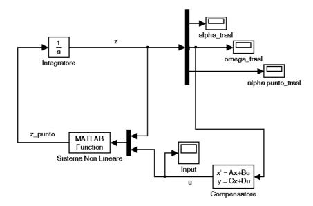
Figure 2: Schema Simulink del sistema non lineare controllato con il regolatore che ha come ingresso  $\tau$  e come uscita  $\theta$ .
