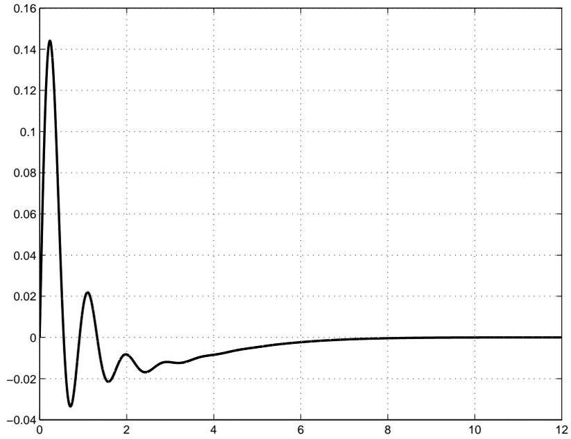
Figure 11: Evoluzione del sistema in anello chiuso nel caso  $\theta(0) = 0, \dot{\theta}(0) = 1$
