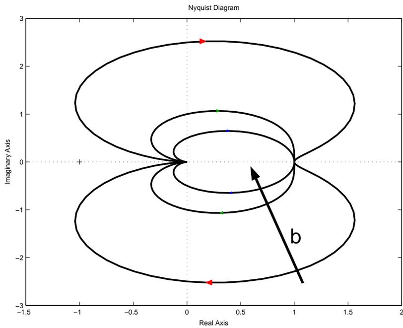
Figure 12: Diagrammi di Nyquist della f.d.t.  $G(s)$  al variare del parametro  $b$
