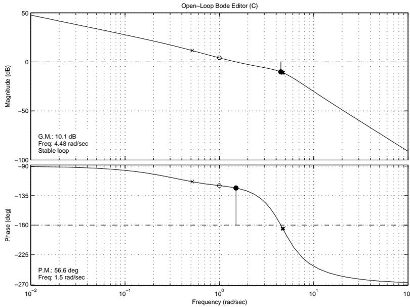
Figure 6: Diagrammi di Bode della f.d.t.  $C_2(s)G_1(s)$  con  $C_2(s) = \frac{1}{s}$
