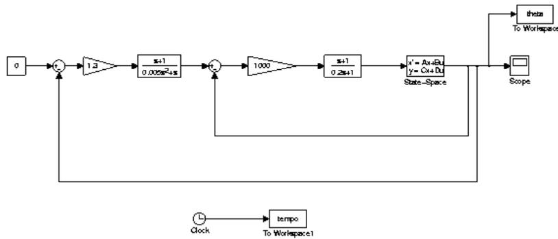
Figure 10: Schema Simulink per la simulazione del sistema in anello chiuso
