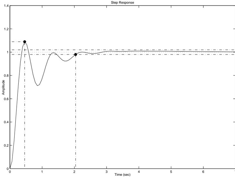
Figure 9: Risposta al gradino della f.d.t. di anello chiuso
