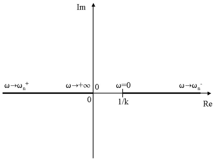
Figure 13: Diagrammi di Nyquist della f.d.t.  $G(s)$  per  $b = 0$
