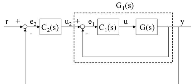
Figure 3: Schema del sistema di controllo da progettare con la tecnica del doppio anello di retroazione
