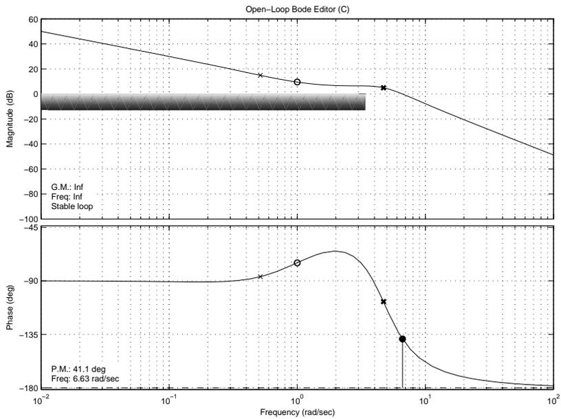
Figure 7: Diagrammi di Bode della f.d.t.  $C_2(s)G_1(s)$  con  $C_2(s) = 1.3 \frac{s+1}{s}$
