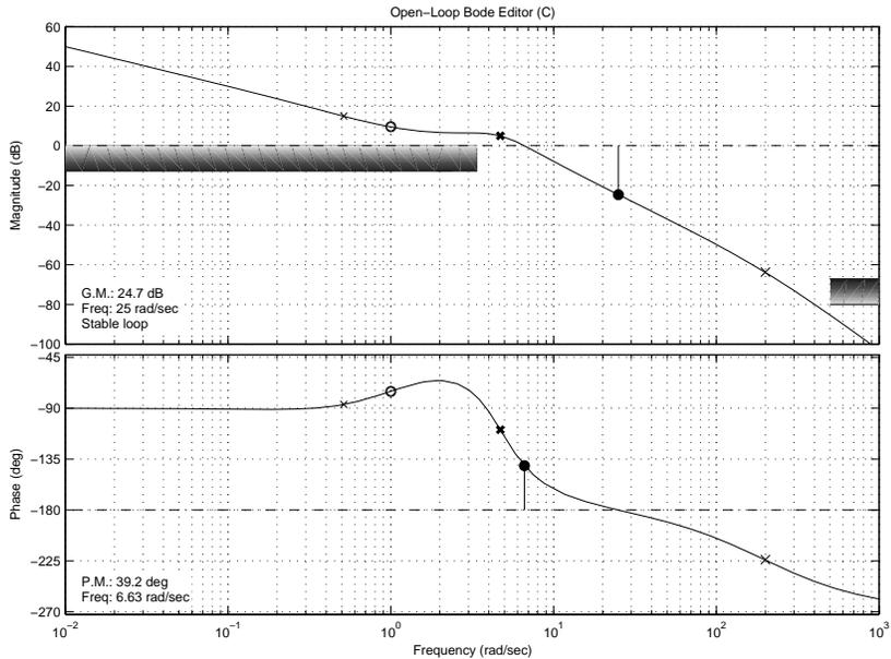
Figure 8: Diagramma di Bode della f.d.t.  $C_2(s)G_1(s)$  con  $C_2(s) = 1.3 \frac{(s+1)}{s(0.005s+1)}$
