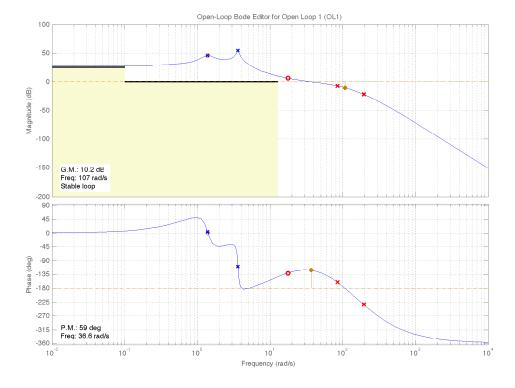
Figura 7: Diagrammi di Bode della f.d.t. C(s)G(s) con le specifiche rispettate.
