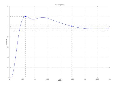
Figura 8: Risposta per ingresso a gradino del sistema controllato per soddisfare le specifiche D.1.
