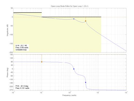
Figura 6: Diagrammi di Bode della f.d.t. G(s)/s con specifiche su banda passante e guadagno in bassa frequenza.
