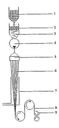
Processo di fabbricazione della fibra multifilamento in PET. 1: grani di PET; 2: riscaldatore; 3: PET fuso; 4: pompa; 5: filiera; 6: filamenti; 7: camera a vapore; 8: fibra multicomponente; 9: bobina di raccolta.
