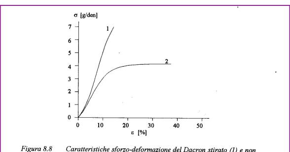
Caratteristiche sforzo-deformazione del Dacron stirato (1) e non stirato (2). Lo sforzo è in questo caso espresso in g/den dove den sta per denier che è la misura della sezione di fibra espressa come il peso in grammi corrispondente a 9000 m di lunghezza (da: L Harmon e MS Hoffman 'Fabrication and Testing of Polyester Arterial Grafts' in Vascular Gtaft Update, ed. KE Kambic, A Kantrowitz e P Sung, ASTM, Philadelphia, 1986).
