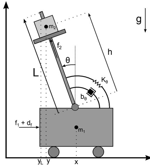
Figura 1: Modello semplificato di trasloelevatore con colonna flessibile
