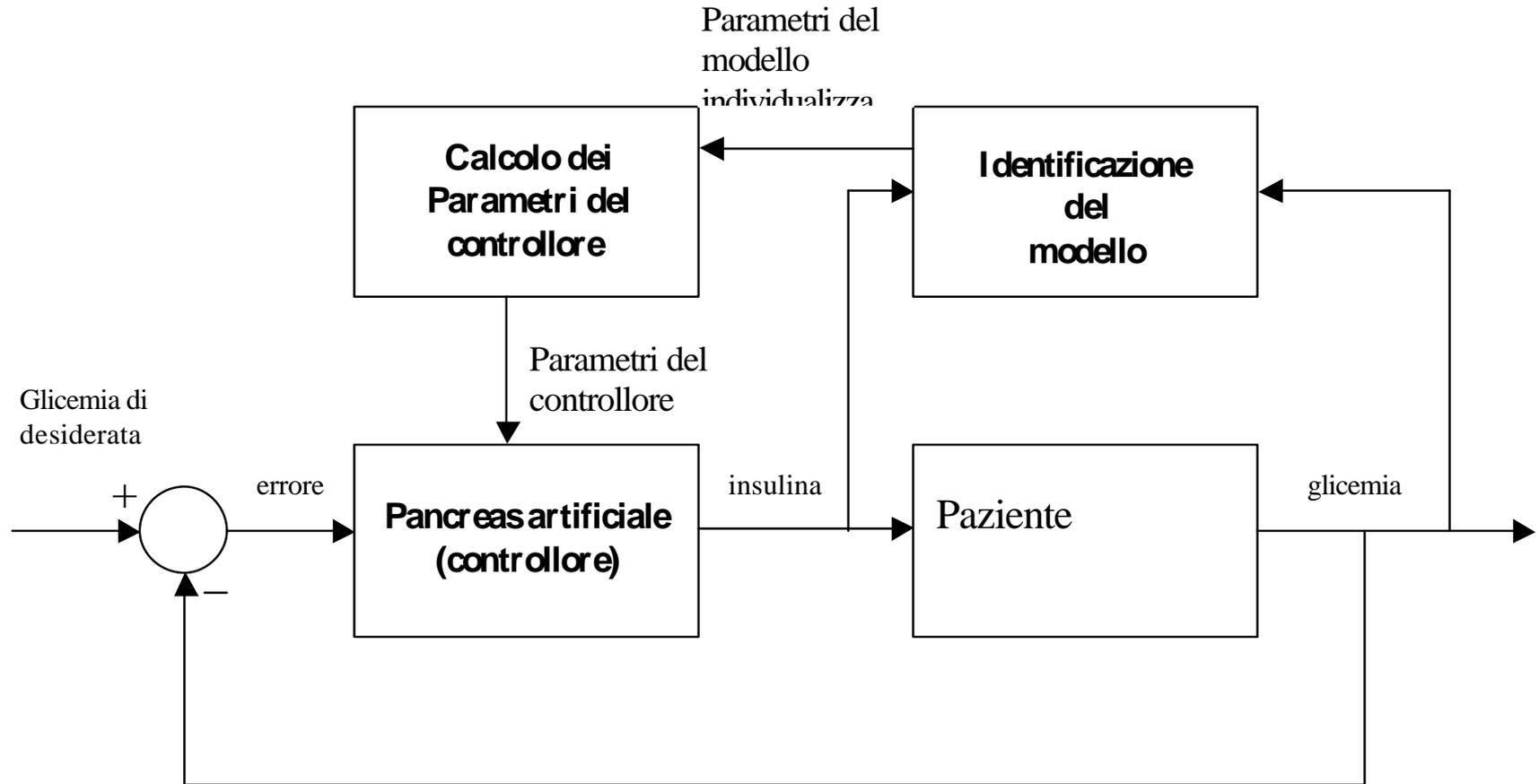
Figura 21: schema di un controllo adattivo self-tuning
