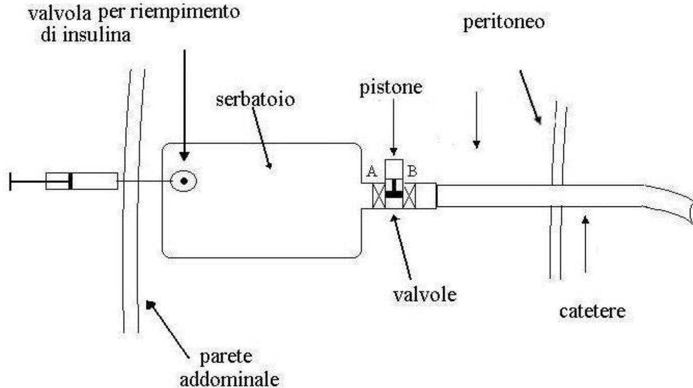
Figura 22: schema di una pompa impiantabile per insulina
