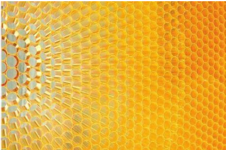
Honeycomb tubolare per l'isolamento dei vetri camera. Produzione Panelite, USA(Foto Panelite).
